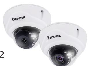
2MP · WDR · 30M IR · P-iris · Mise au point à distance · Smart IR · IP66 · IK10 · Rotation vidéo · Conditions climatiques extrêmes · Anti-brouillard
