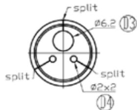
橡膠密封圈上的電纜孔直徑顯示在右側。請通過電纜孔正確安裝防水電纜密封套和電纜，以獲得 IP66 防水功能。
