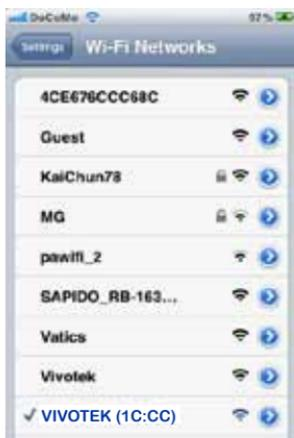
2. Sobald die Verbindung besteht, schließen Sie die Kamera an einen anderen AP an. Öffnen Sie einen Browser und geben Sie in die Adresszeile für die URL die Standard-IP der Kamera (192.168.1.1) ein. Sobald die Verbindung besteht, geben Sie manuell die SSID und den Sicherheitsschlüssel für den Zugriff auf den anderen AP ein, oder suchen Sie mit der Funktion **“Search your AP”** (AP suchen) nach anderen APs in der Nähe.
